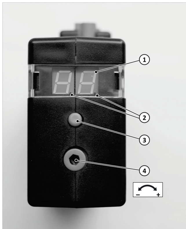
Fig. 99: Ajuste de las revoluciones del ventilador en la interfaz
