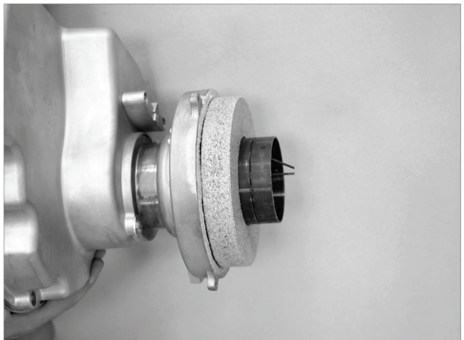
Fig. 53: Colocación del ladrillo de la puerta de la caldera
