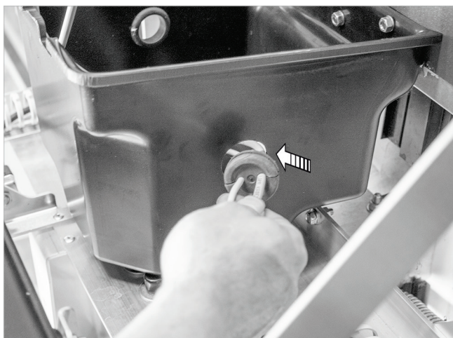
Fig. 32: Insertar herméticamente el paso de cables
