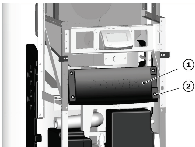
Fig. 95: Fijar la tapa del módulo de red
