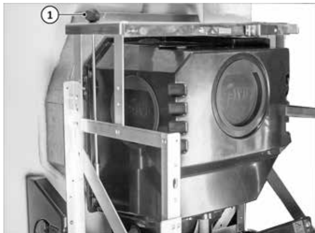
Fig. 46: Llave de tubo en posición de estacionamiento
