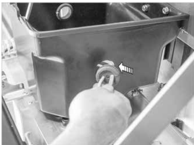
Fig. 32: Insertar herméticamente el paso de cables
