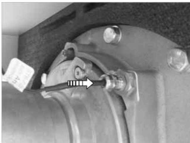
Fig. 68: Introducción del termostato mecánico de seguridad
