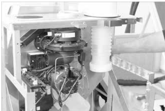
Fig. 61: Alineación recta de la pieza de conexión para la salida de humos
