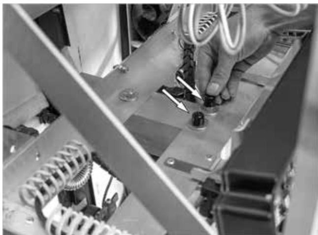
Fig. 30: Cubrir las cabezas de los tornillos
