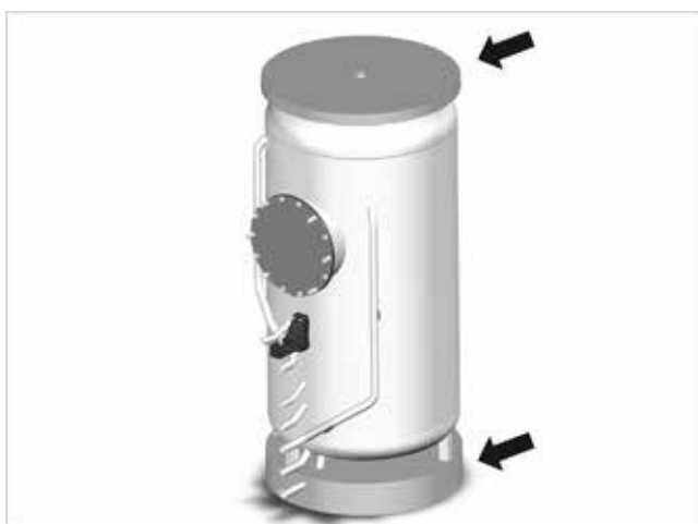
Fig.4: Posicionar los discos para base y para la tapa
