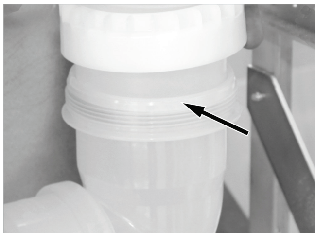
Fig. 39 : vissage du coude d'évacuation des gaz à la verticale
