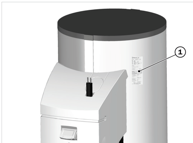
Fig.108 : copie de la plaque signalétique (1) collée sur l'isolation
