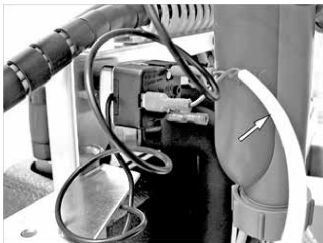
Fig. 70: mSTB et câble de raccordement
