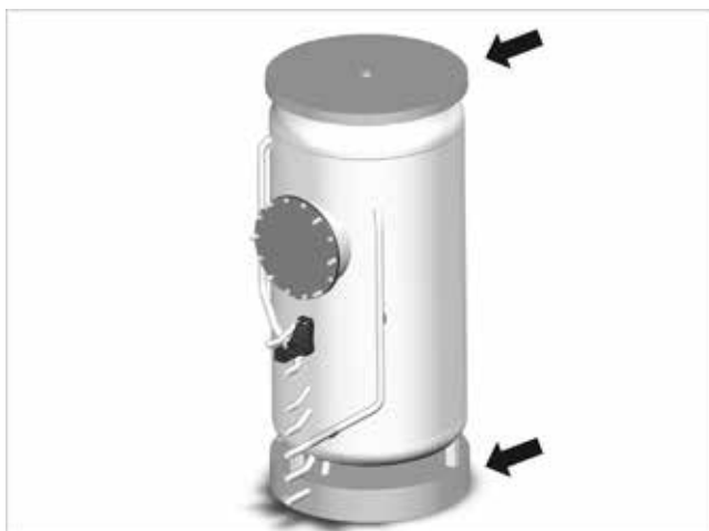
Fig.4 : mise en place des ronds de socle et de couvercle
