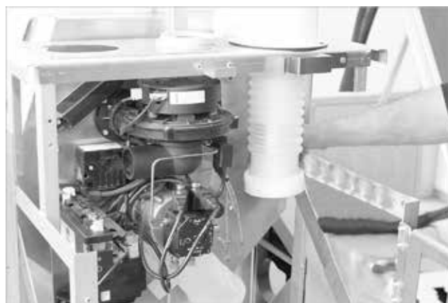
Fig. 61 : positionnement droit du raccord d'évacuation des gaz
