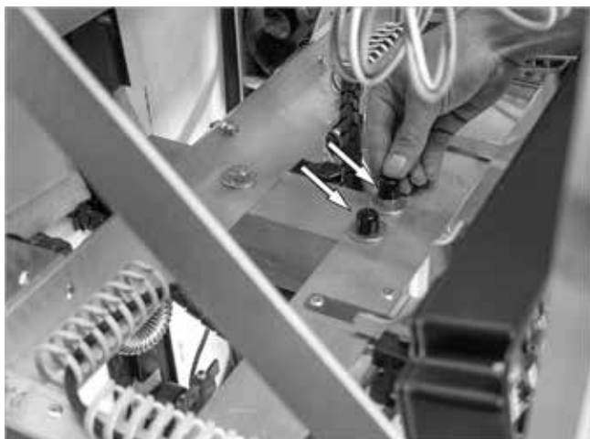
Fig. 30 : couvrir les têtes de vis de la console
