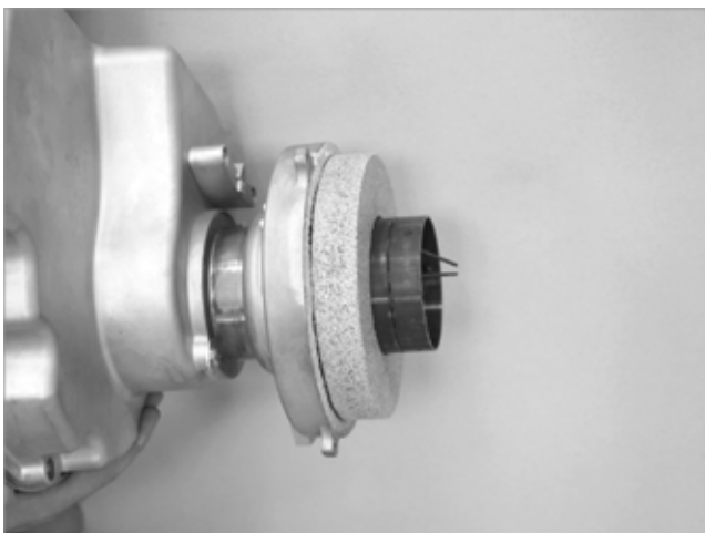
Fig. 53 : pose de la brique réfractaire de porte de chaudière
