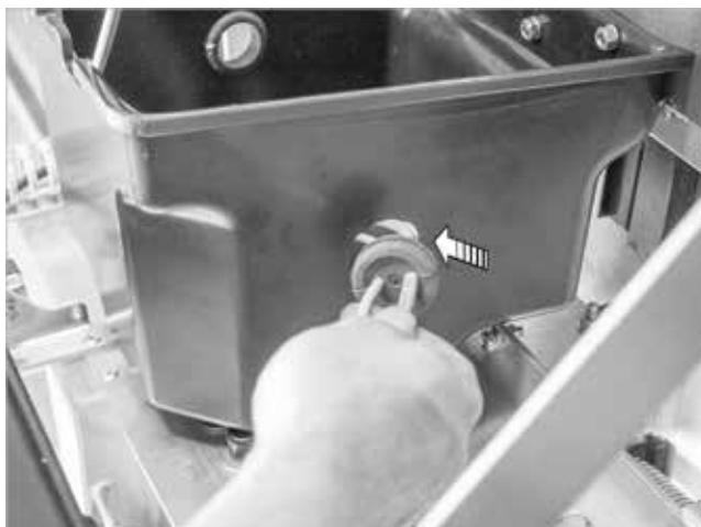
Fig. 32 : passage étanche du câble du brûleur
