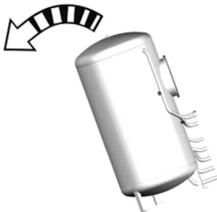
Fig.1 : basculement de l'accumulateur
