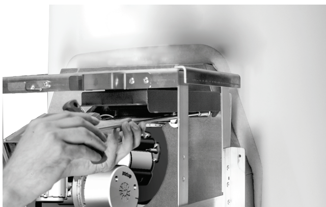
Afb. 34: Houder balgafdichting vastschroeven
