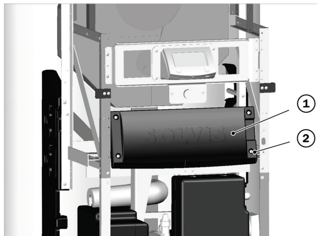
Afb. 95: Deksel van de netmodule bevestigen
