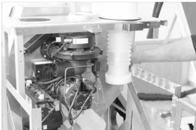
Afb. 61: Rookgasaansluitstuk recht uitlijnen.
