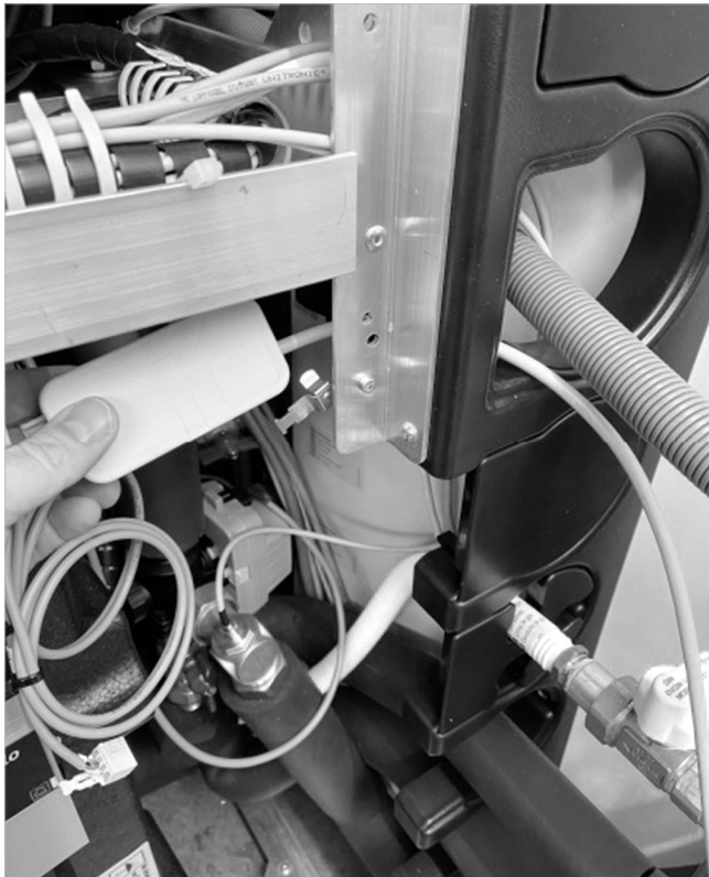
Abb. 18: Kabelabschnitt mit Schirmklemme durchstecken
