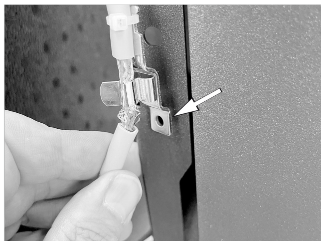
Abb. 25: Bohrung für Schirmklemme erstellen
