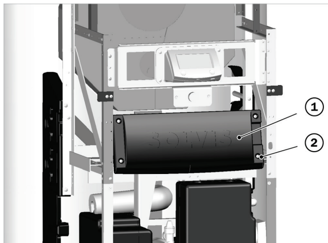
Abb. 27: Deckel der Netzbaugruppe befestigen
