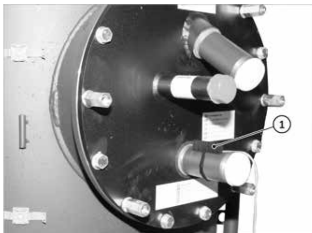
Abb. 4: Sensor S4 (1) montiert
