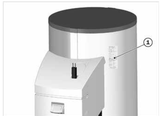
Abb.30: Typenschildkopie (1) auf Isolierung geklebt
