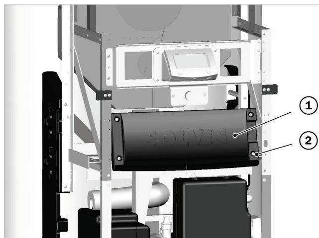
Fig. 27: fissaggio del coperchio del gruppo di rete
