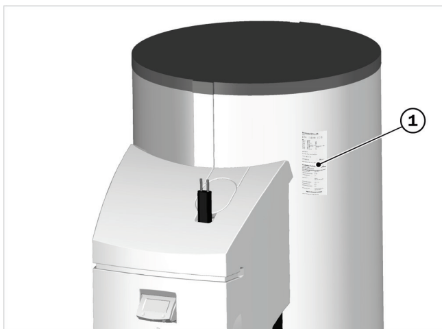
Fig.30: copia della targhetta (1) applicata sull'isolamento
