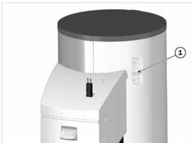
Fig.30: copia della targhetta (1) applicata sull'isolamento
