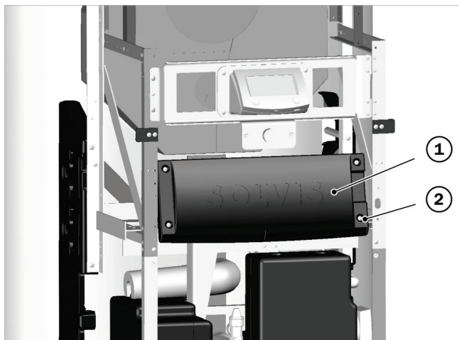
Afb. 27: Deksel van de netmodule bevestigen
