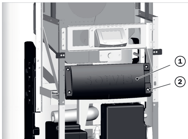
Fig. 19: Fijar la tapa de la placa de circuitos impresos de red
