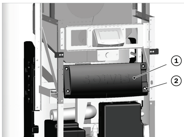
Fig. 24 : Fixez le couvercle de l'élément de réseau
