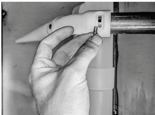
Fig. 19 : sécuriser la lance de chargement avec le rivet d'écartement
