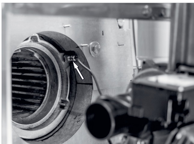
Fig. 31: Inserting the eSTL
