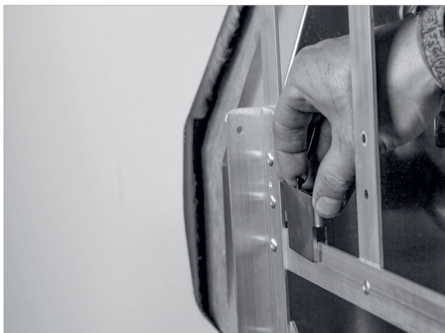
Fig. 116: fissaggio dei ganci di sollevamento
