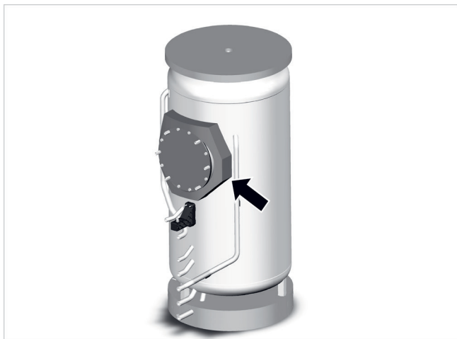
Fig.5: montaggio del collare della flangia
