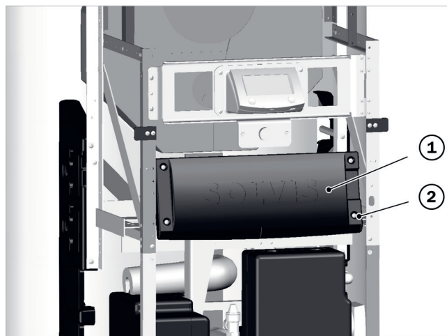
Fig. 99: Fissaggio del coperchio della scheda di rete
