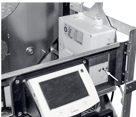
Fig. 125: Pulsante di rilascio scatola di connessione HPT
