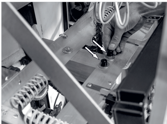
Fig. 34: Copertura delle teste delle viti
