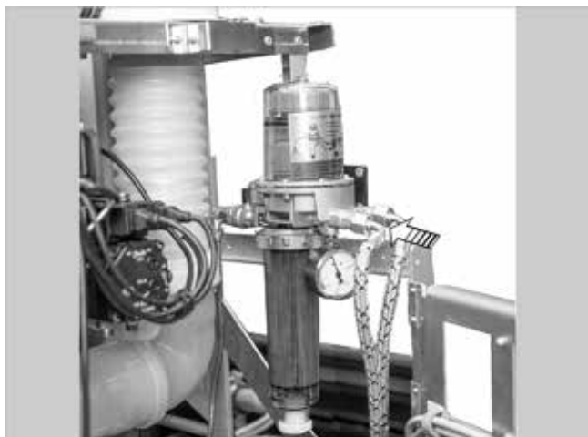
Fig. 69: allacciamento della tubazione dell'olio
