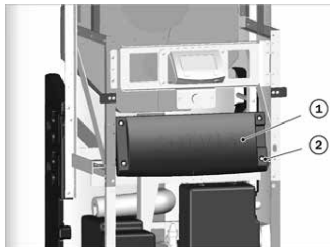
Fig. 99: Fissaggio del coperchio della scheda di rete
