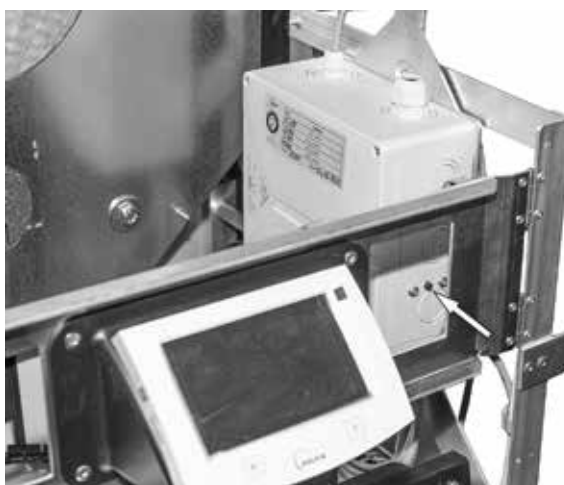
Fig. 125: Pulsante di rilascio scatola di connessione HPT
