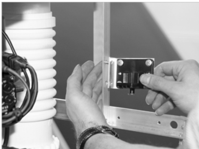
Fig. 67: Fissaggio del supporto del filtro dell'olio
