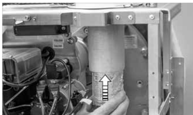
Fig. 62: Montaggio fonoassorbente per la parte interna del tubo
