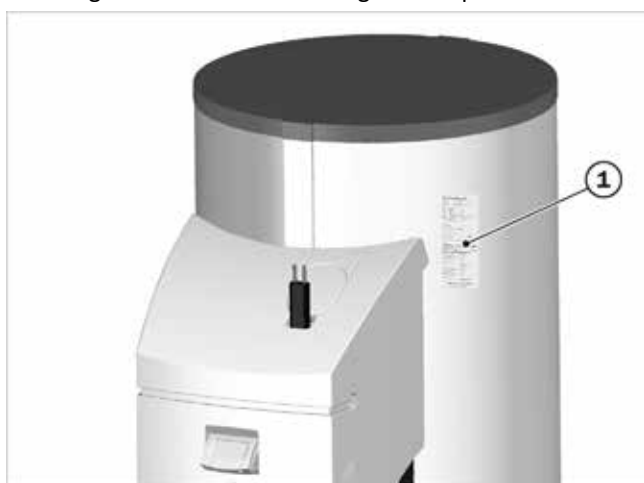
Fig.111: copia della targhetta (1) applicata sull'isolamento
