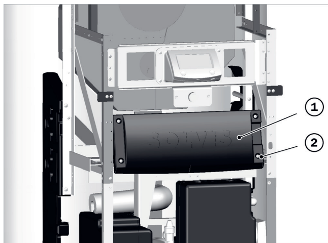
Fig. 99: Fijar la tapa de la placa de circuitos impresos de red
