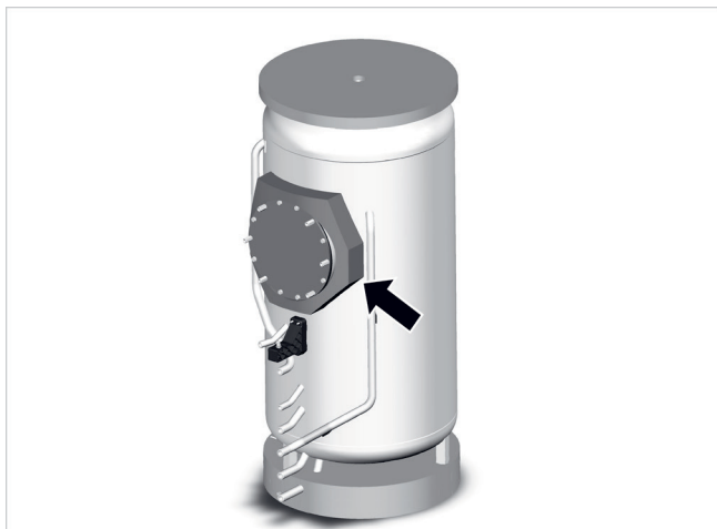
Fig.5: Montar la brida de cuello
