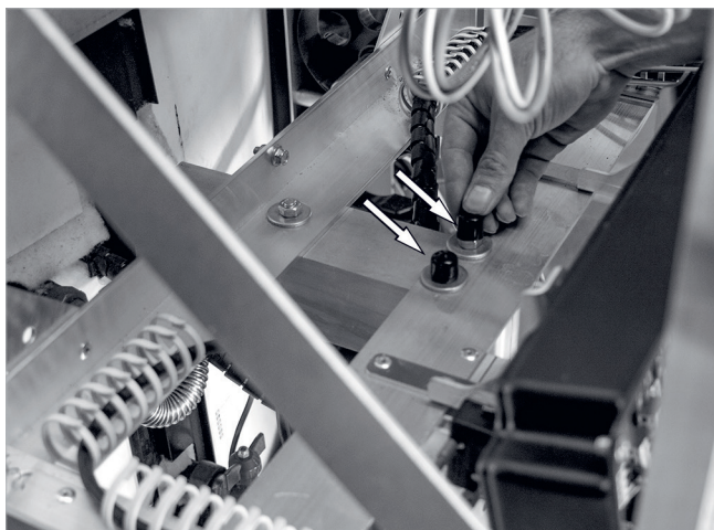
Fig. 34: Cubrir las cabezas de los tornillos
