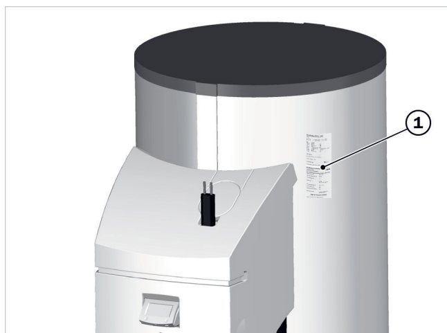
Fig.111: Copia de la placa de características (1) pegada al aislamiento.
