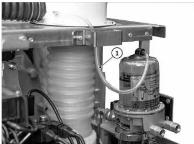
Fig. 71: Manguera de purga de aire montada
