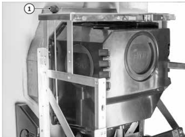
Fig. 50: Llave de tubo en posición de estacionamiento
