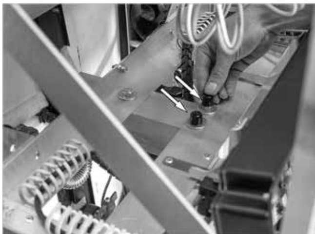
Fig. 34: Cubrir las cabezas de los tornillos
