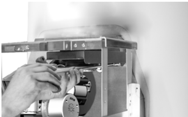
Fig. 38: Atornillar el soporte del fuelle de estanqueidad
