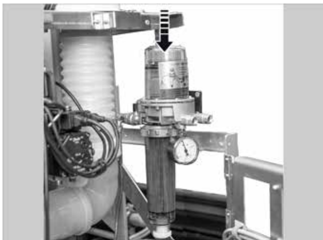
Fig. 68: Montaje del filtro de gasóleo
