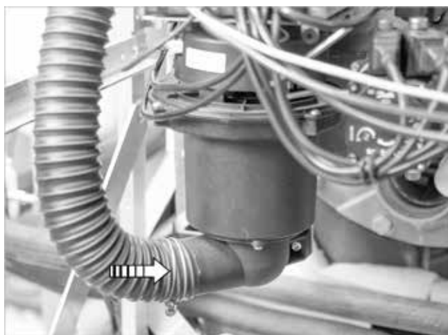
Fig. 59: Fijar el tubo de entrada de aire al ventilador
