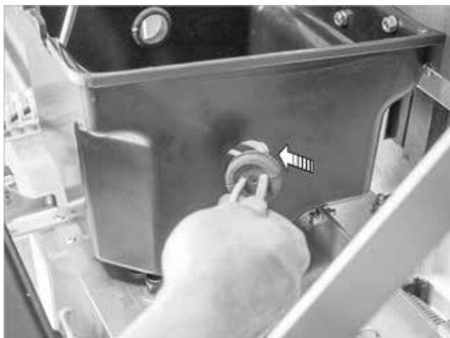
Fig. 36: Insertar herméticamente el paso de cables
