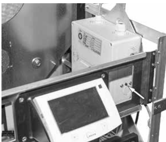
Fig. 125: Botón de desbloqueo caja de conexión HPT
