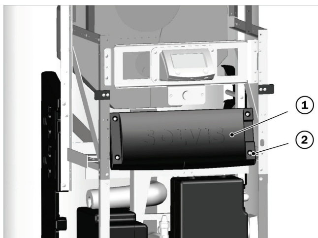
Fig. 98 : Fixez le couvercle de l'élément de réseau
