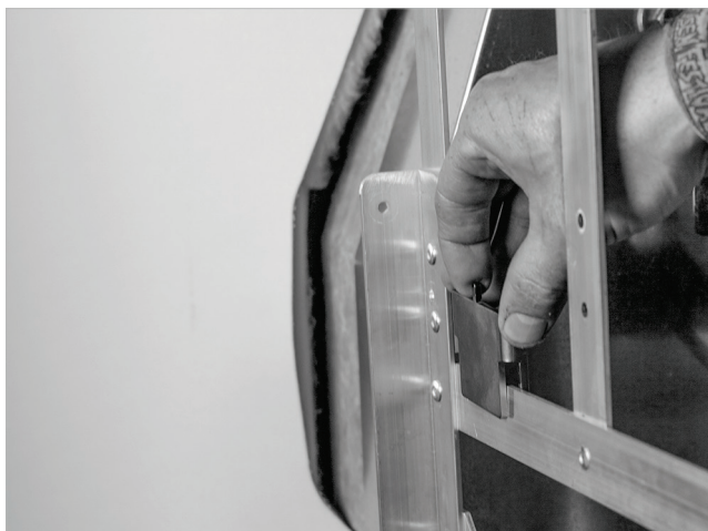
Fig. 113 : accrocher les crochets de fixation
