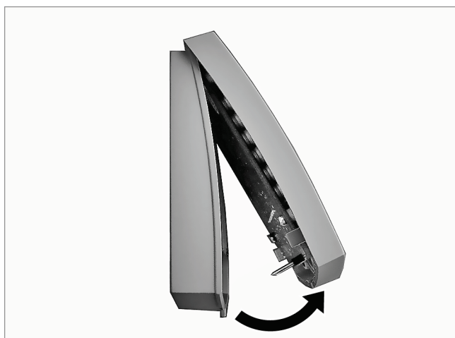
Fig. 94 : Ouverture du boîtier
