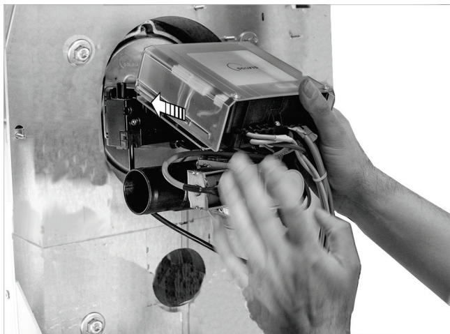
Fig. 31 : montage du brûleur
