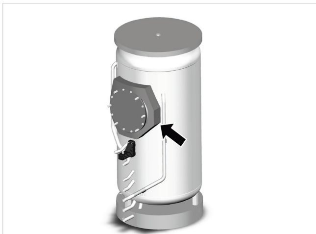
Fig.5 : montage de la collerette
