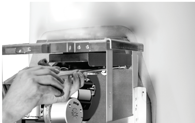
Fig. 37 : visser le support du soufflet d'étanchéité
