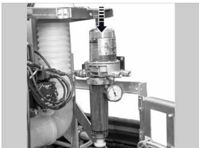
Fig. 67 : enficher le filtre à fioul
