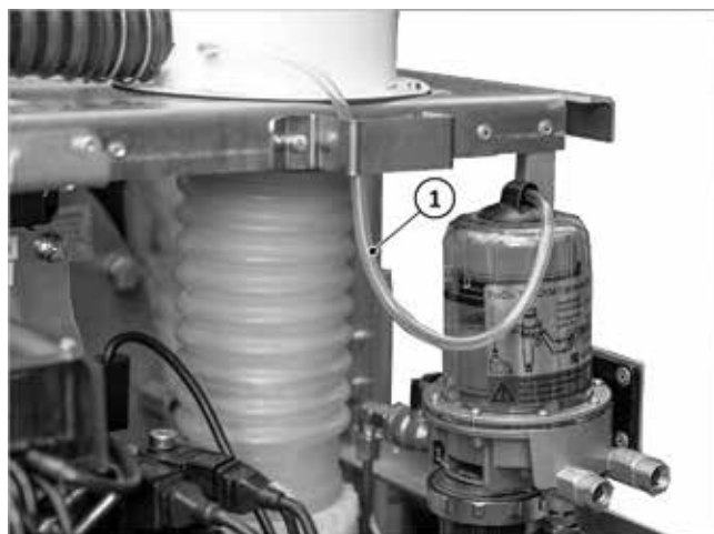
Fig. 70 : tuyau de purge monté
