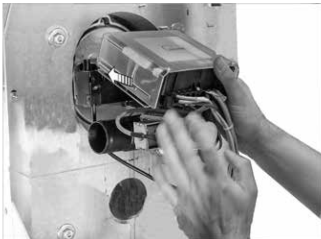
Fig. 31 : montage du brûleur
