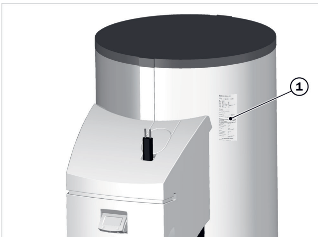
Afb.111: Kopie typeplaatje (1) op isolatie geplakt
