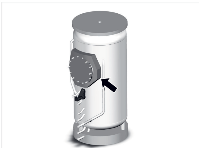
Afb.5: De flenshalsschaal monteren
