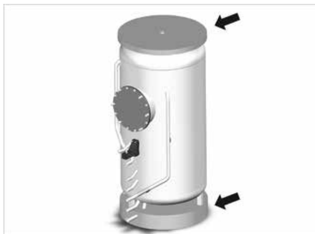
Afb.4: Ronde bodem en rond deksel plaatsen
