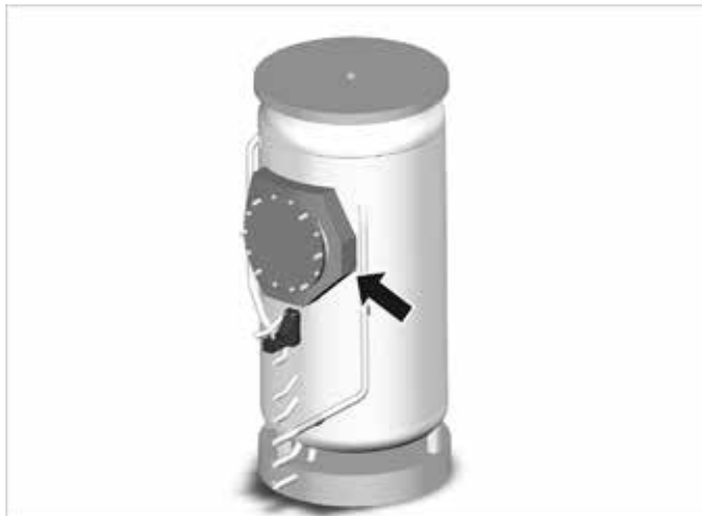
Afb.5: De flenshalsschaal monteren
