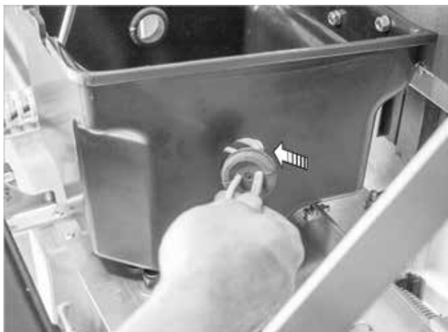
Afb. 36: Branderkabel luchtdicht doorvoeren
