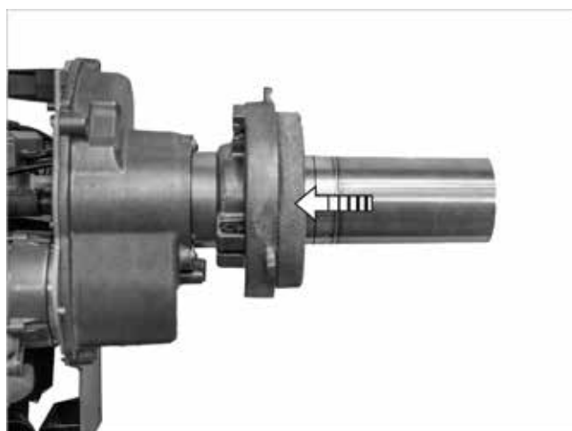
Afb. 56: Ketel deurisolatie plaatsen
