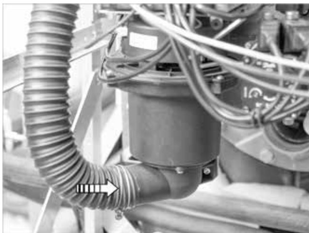
Afb. 59: Toevoerluchtslang op de ventilator aansluiten
