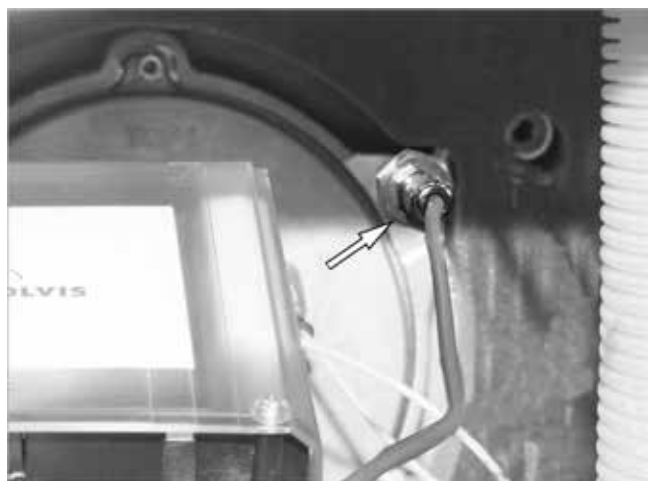
Fig. 50: Inserting the eSTL
