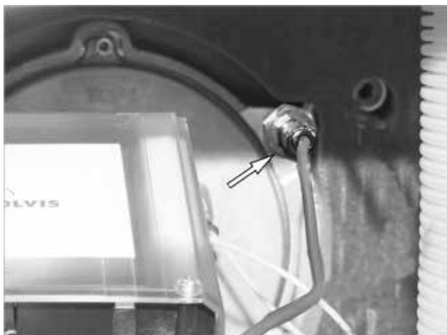
Fig. 69: Inserting the eSTL
