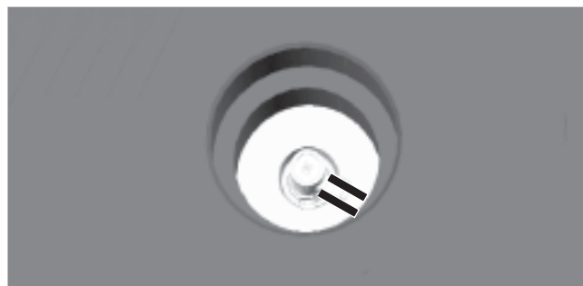
Fig. 135: tubo flessibile di sfiato dello sfiatatoio
