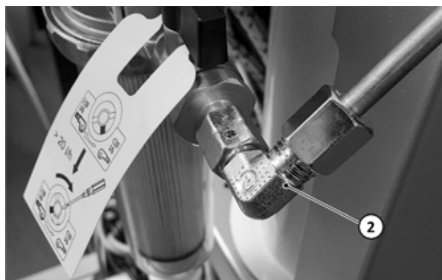
Fig. 78: Fissaggio della tubazione di alimentazione del gasolio al filtro
