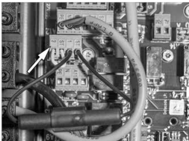
Fig. 57: Inserire la presa di collegamento
