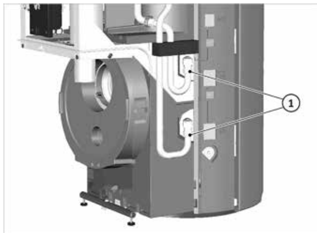
Fig. 31: Controllare/serrare gli attacchi della SCR
