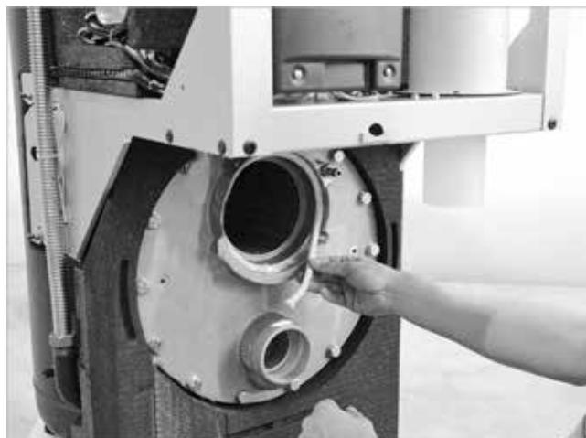
Fig. 46: Inserire il cordoncino di tenuta del bruciatore
