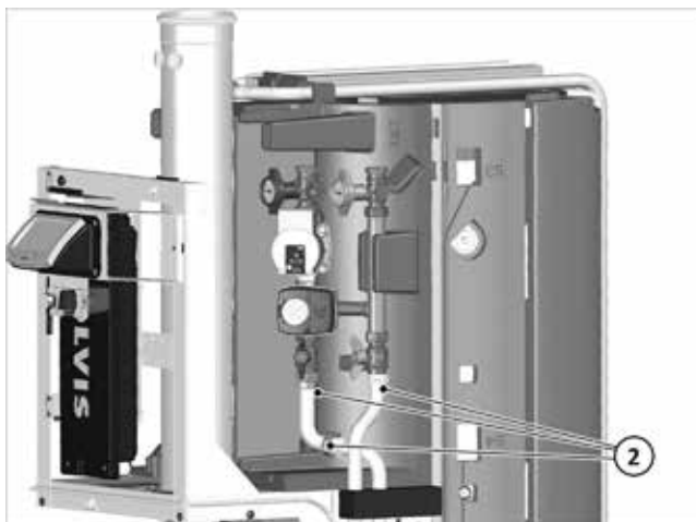
Fig. 32: Controllare/serrare gli attacchi angolo di mandata/ritorno
