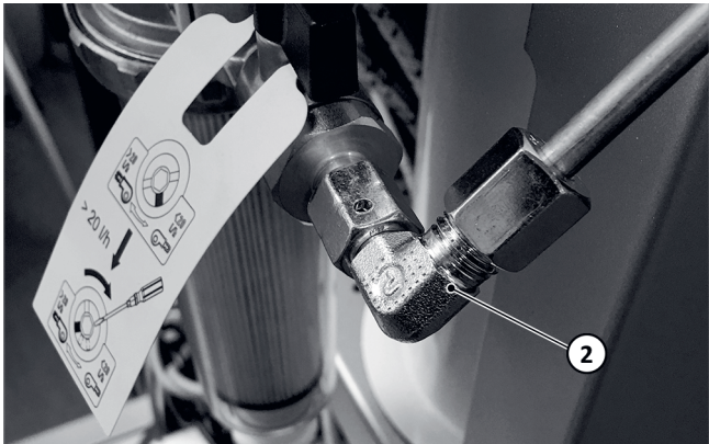
Fig. 78: Conexión de la tubería de alimentación de gasóleo en el filtro
