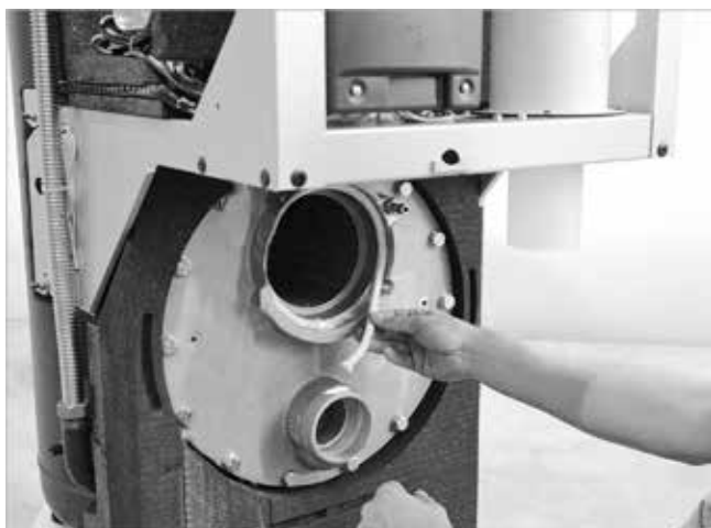
Fig. 46: Colocación del cordón de cierre hermético
