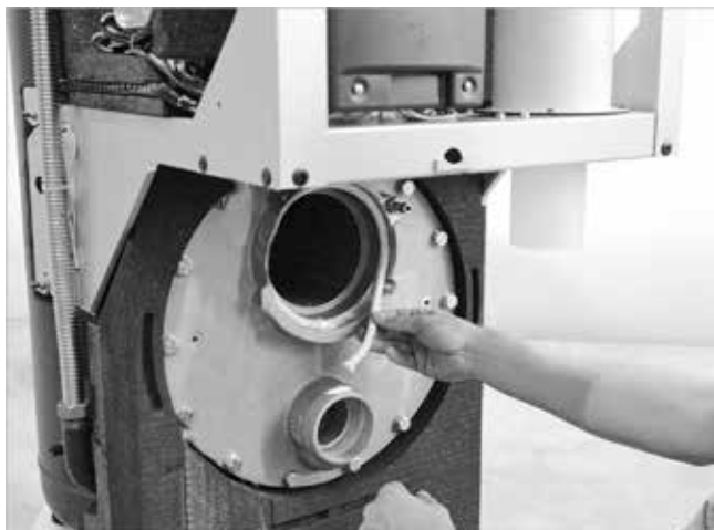
Fig. 64: Colocación del cordón de cierre hermético
