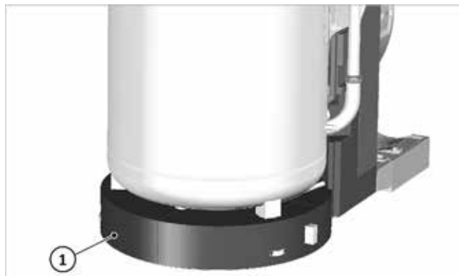
Fig. 13: Coloque los discos para la base debajo del acumulador
