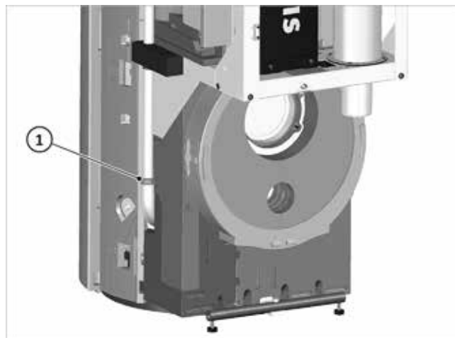
Fig. 26: Control/reapriete de la unión roscada del retorno
