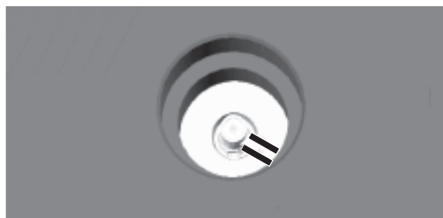
Fig. 135: Tubo en el purgador de aire
