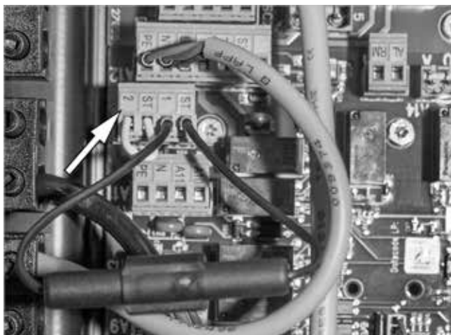
Fig. 57: Conexión de la regleta de hembrillas
