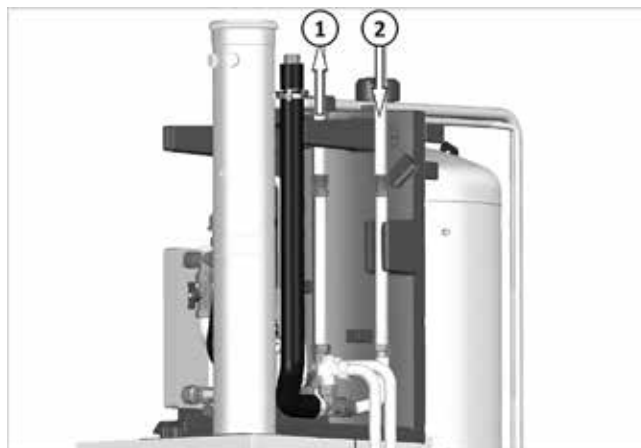
Fig. 39: Conexión de H-VL/H-RL desde arriba
