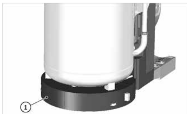
Fig. 13 : installation du socle sous l'accumulateur
