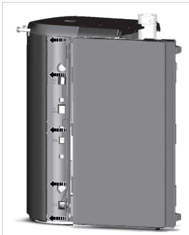
Fig. 127 : insertion de la pièce latérale
