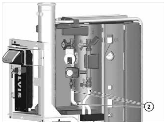
Fig. 32 : contrôler / resserrer les raccords des coudes aller et retour
