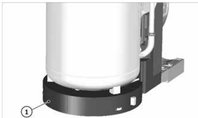
Afb. 13: Rond vloerdeel onder de boiler leggen
