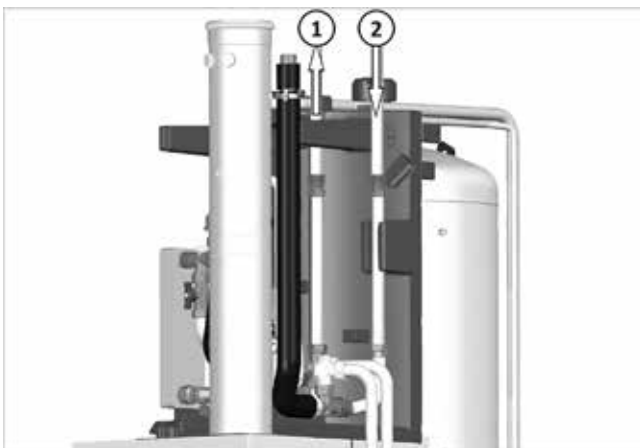
Afb. 39: H-VL/H-RL-aansluiting van bovenaf
