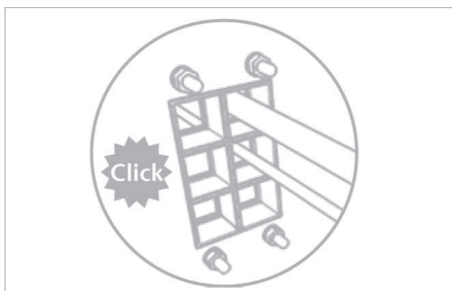
Afb. 54: Plaatsen van de inlay
