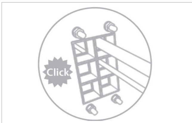
Afb. 72: Plaatsen van de inlay
