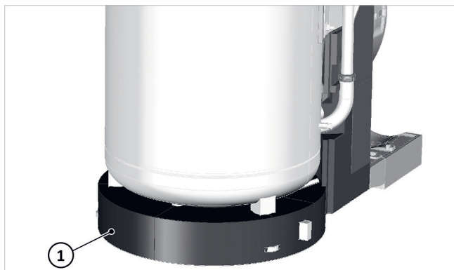
Afb. 13: Rond vloerdeel onder de boiler leggen
