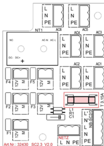
Afb. 23: Uitbreidingsprintplaat voor de netwerkkaart van de SolvisControl 3
