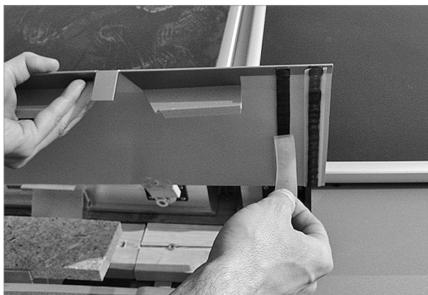
Abb. 73: An der Unterseite des Kreuzungsbleches Schutzstreifen abziehen
