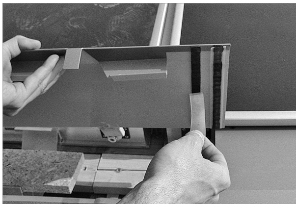
Fig. 73: rimozione nella parte inferiore della lamiera a incrocio la striscia di protezione.
