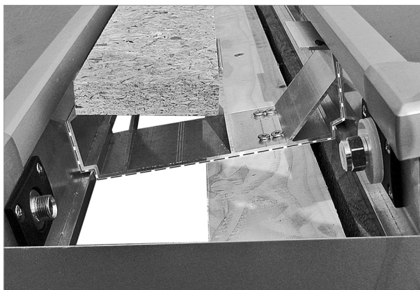
Fig. 62: Posición de los distanciadores en los colectores
