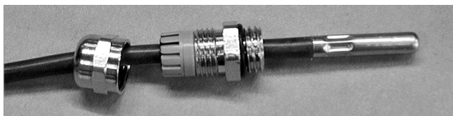
Fig. 91: Deslizar el racor PG sobre el sensor sumergible
