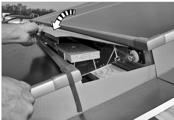
Fig. 70: Insertar la primera chapa intermedia en la ranura, colocar y presionar
