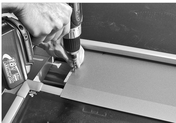
Afb. 72: Tussenplaat ca. 10 mm vanaf de linker buitenkant vastschroeven
