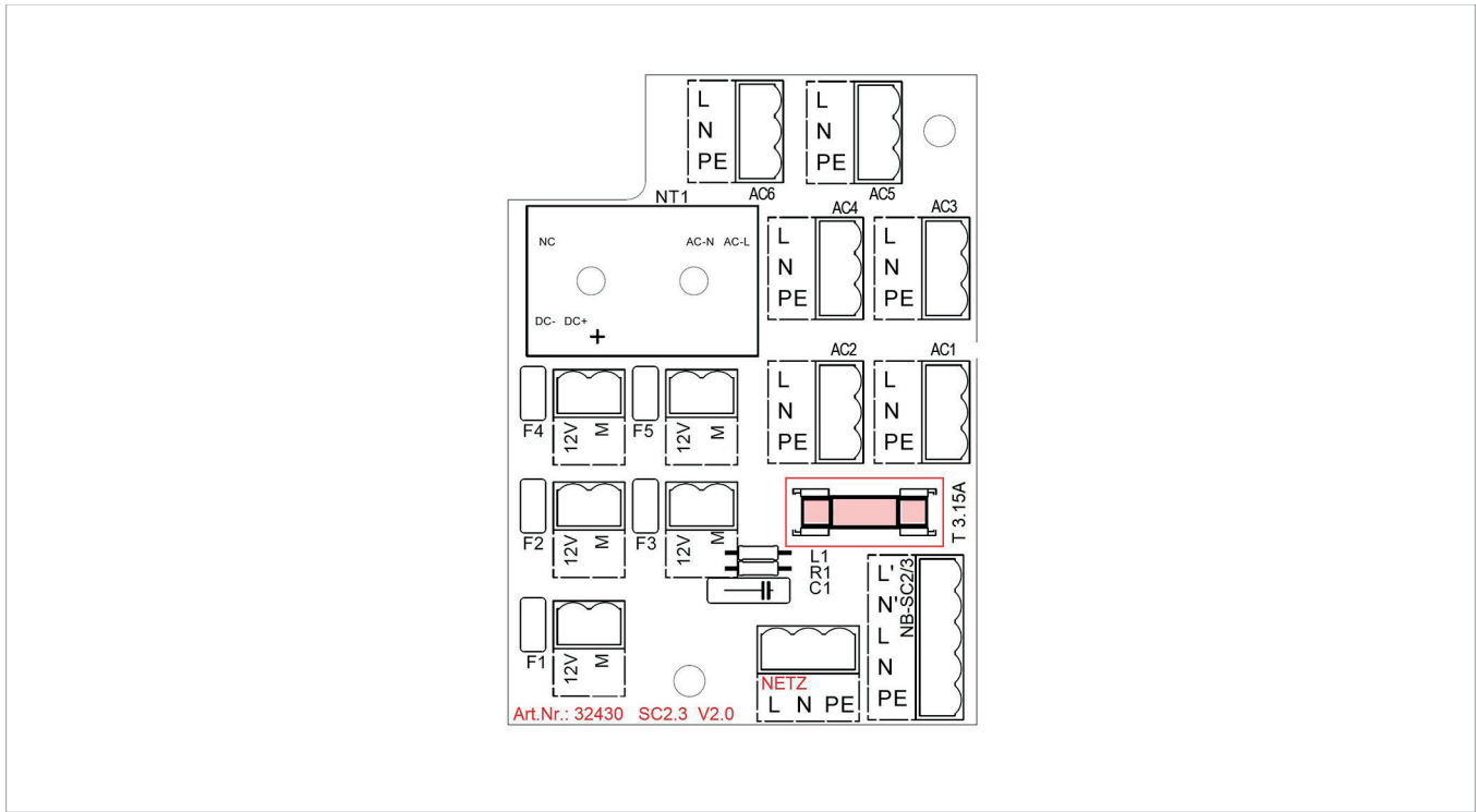
Abb. 29: Erweiterungsplatine für die Netzplatine der SolvisControl 3
