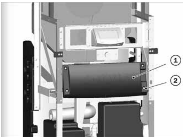
Abb. 21: Deckel der Netzplatine befestigen
