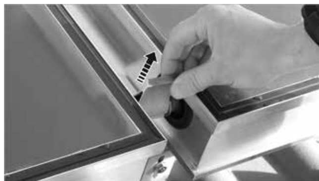
Fig. 17: Retirar manguito distanciador
