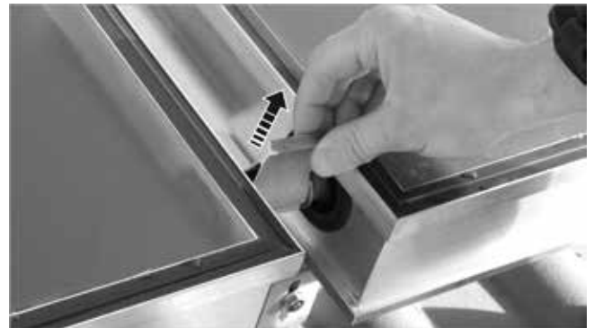
Fig. 35: Retirar manguito distanciador
