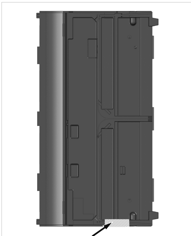
Abb. 41: Betreffendes EPP-Seitenteil beschneiden
