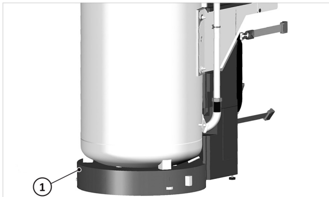
Abb. 12: Bodenronde unter den Speicher legen
