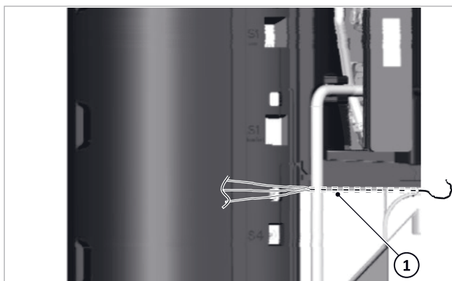
Abb. 19: Verlauf des Sensorkabelbaums
