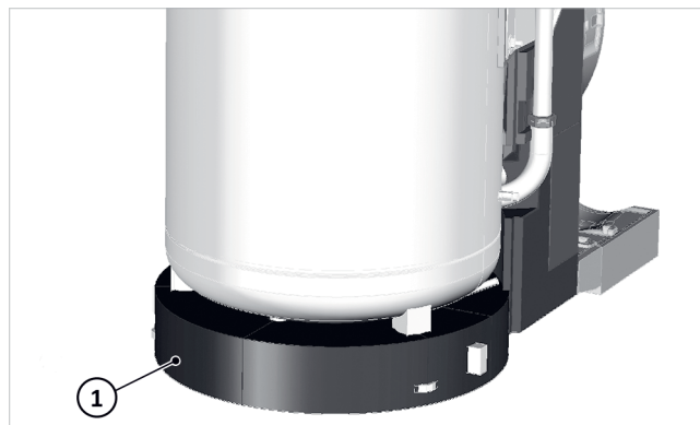
Abb. 13: Bodenrunde unter den Speicher legen
