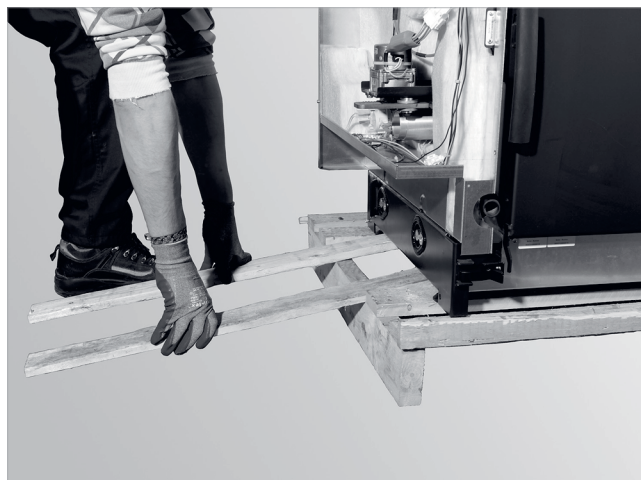
Abb. 7: Verschlagbretter an Rampe legen
