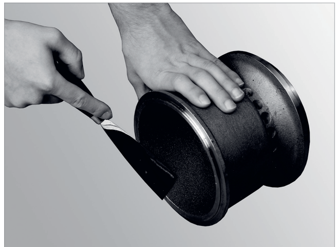
Abb. 149: Konus mit Spachtel reinigen
