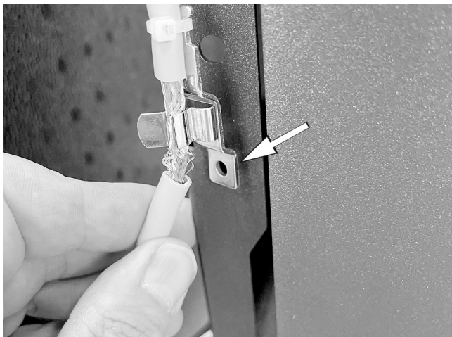
Abb. 6: Schirmklemme an der Netzplatinentür von SolvisBen befestigen
