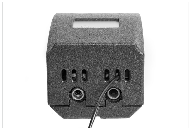
Abb. 9: Modbus-Leitung durch Lüftungsschlitz geführt
