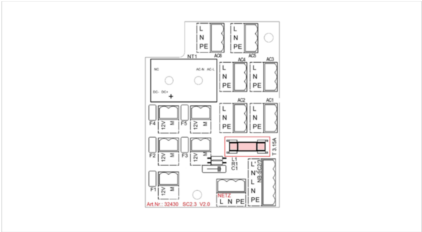
Fig. 29: Scheda di ampliamento per il gruppo di rete di SolvisControl 3
