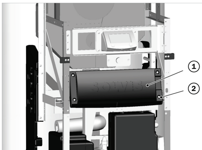
Fig. 21: Fissaggio del coperchio della scheda di rete
