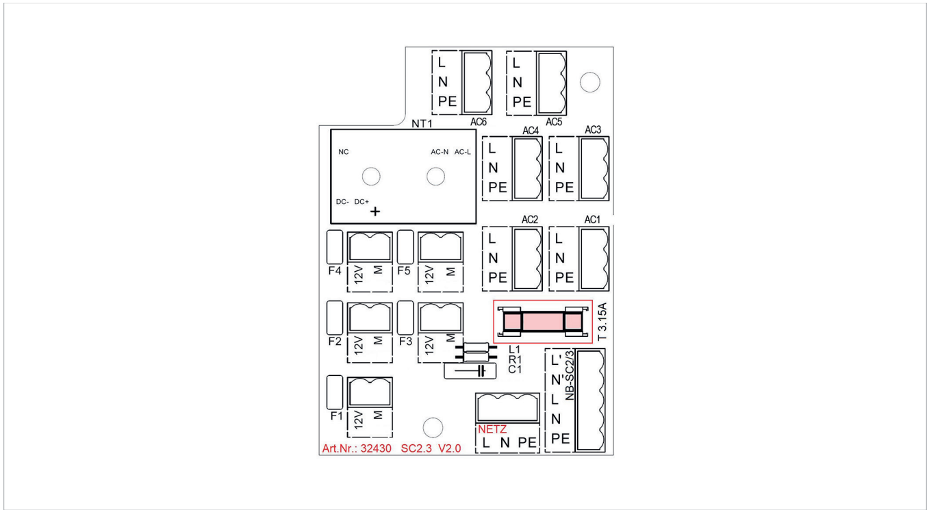
Afb. 18: Uitbreidingsprintplaat voor de netwerkkaart van de SolvisControl 3
