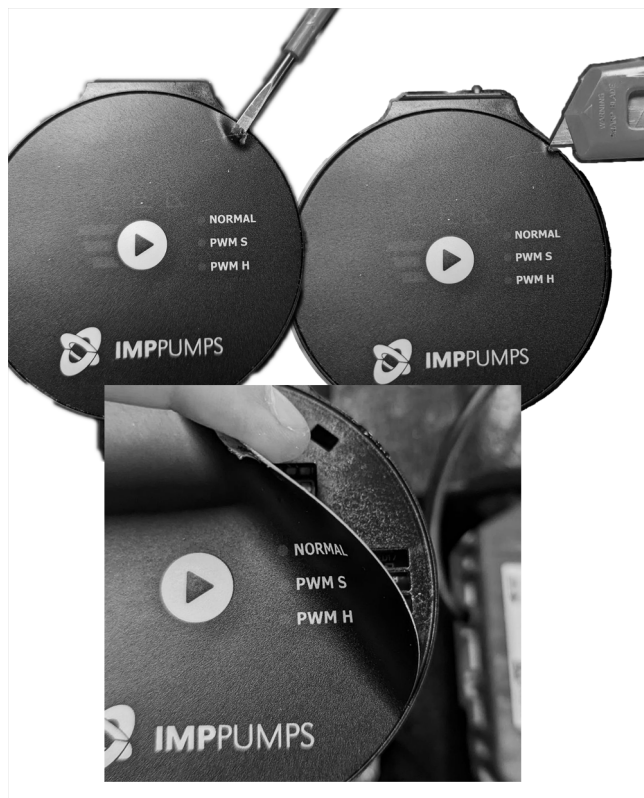
Abb. 2: Verklebte Bedienfeldfolie mit Schraubendreher oder Cuttermesser lösen
