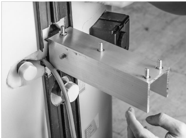
Abb. 6: Kabelführung aus der Isolierung und Halterung des Gestells
