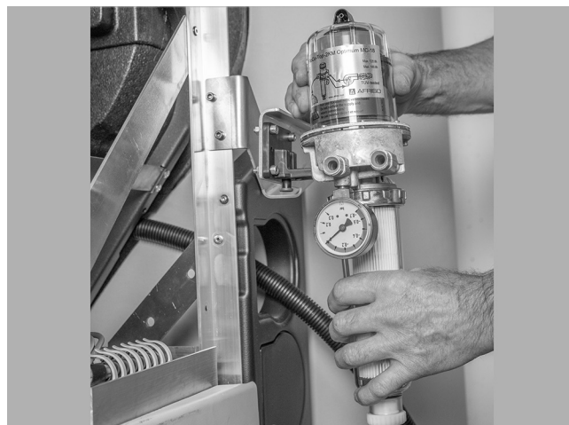
Fig. 65: Inserire il filtro dell'olio
