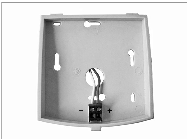
Fig. 115: collegamento dell'elemento di regolazione ambiente
