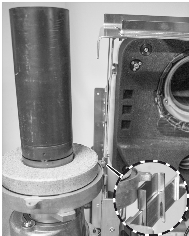
Fig. 139: bruciatore in posizione di parcheggio
