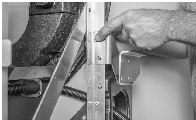
Fig. 63: Fissare il supporto del filtro dell'olio
