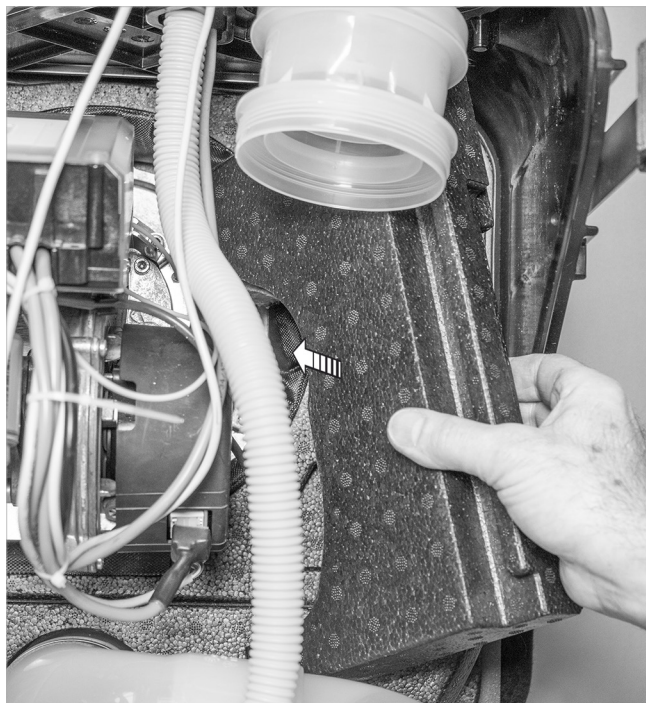
Fig. 92: Installazione dell'isolamento della flangia anteriore destra (parte II)
