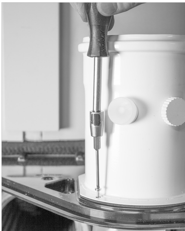
Fig. 53: Montare il raccordo scarico fumi
