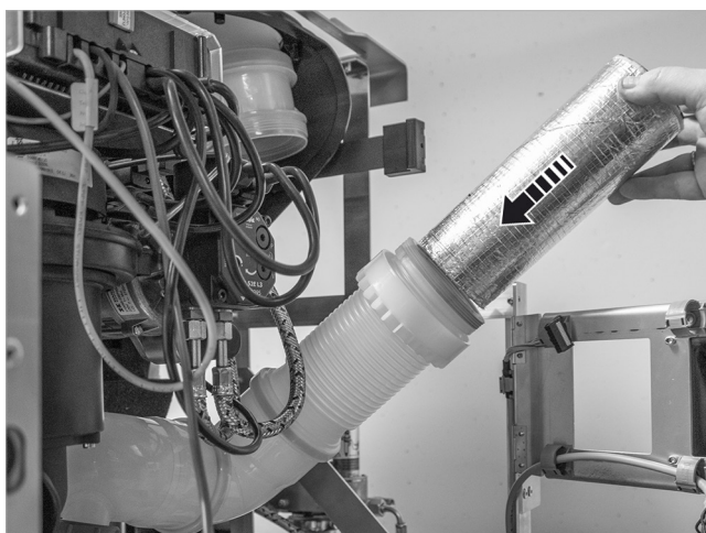
Fig. 79: Inserire il silenziatore lungo sotto
