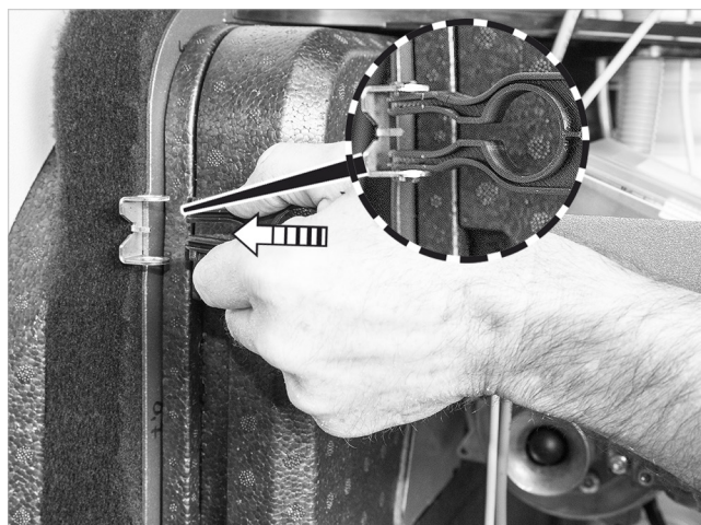
Fig. 95: Montaggio della guida
