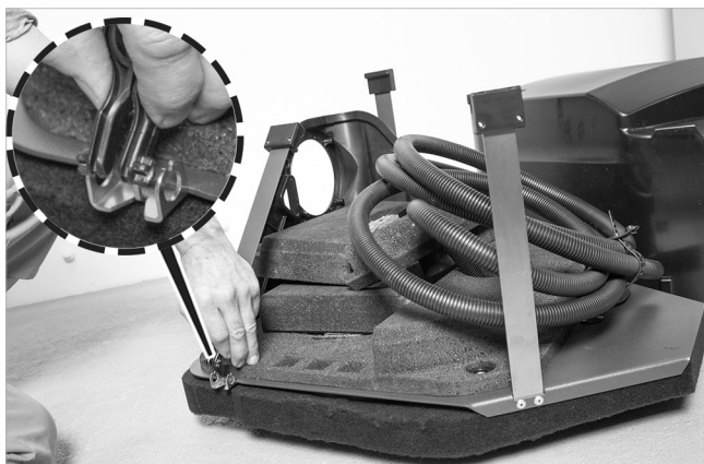
Fig. 12: Smontaggio della barra di bloccaggio
