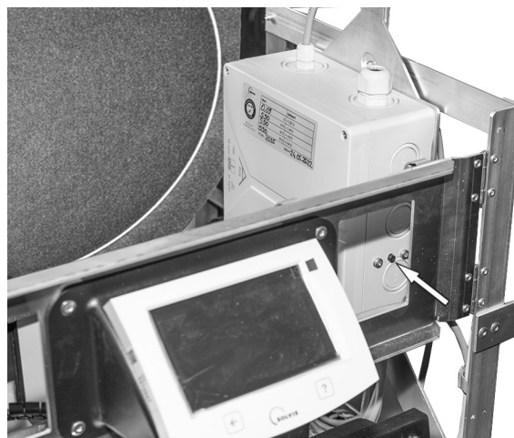
Fig. 147: Pulsante di rilascio scatola di connessione HPT
