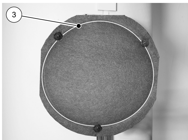
Fig. 10: Isolamento flangia Solo montato
