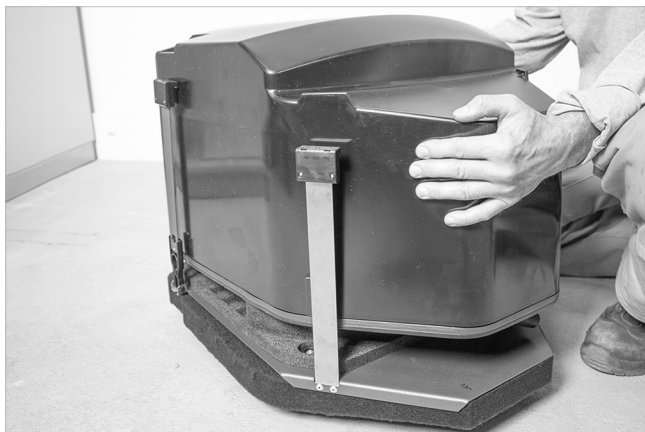
Fig. 11: Smontaggio della camera di aspirazione
