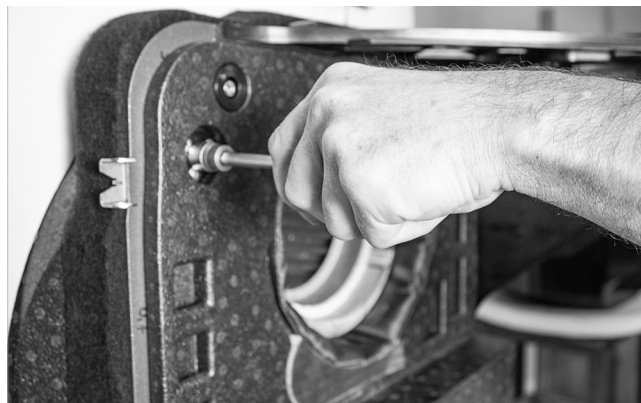
Fig. 14: Fissare la parete posteriore della camera di aspirazione
