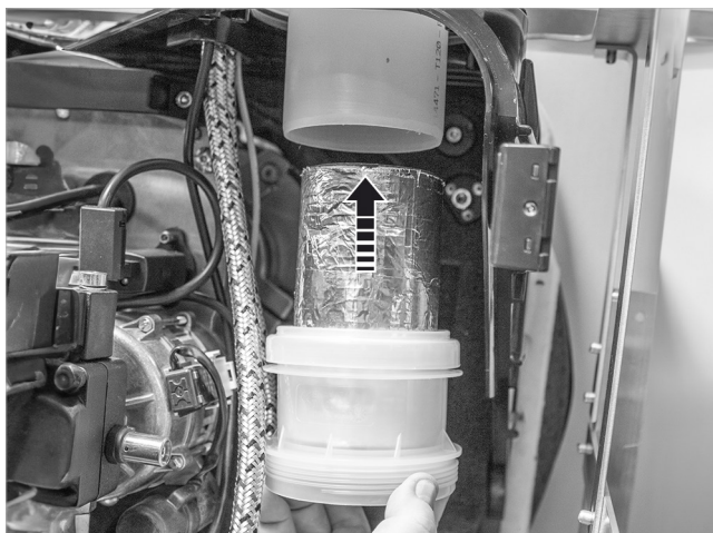
Fig. 78: Inserire il silenziatore corto sopra
