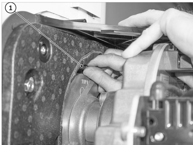
Fig. 61: Fijar el quemador con las tuercas largas (1)
