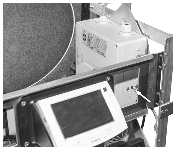
Fig. 147: Botón de desbloqueo caja de conexión HPT
