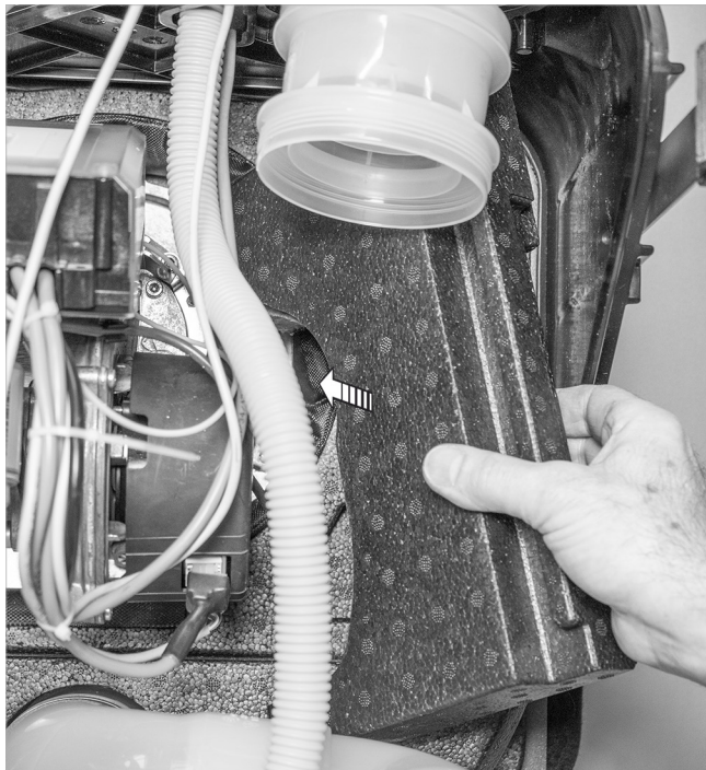
Fig. 92: Montaje del aislamiento delantero derecho de la brida (parte II)
