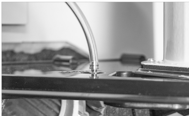
Fig. 55: Montar el tubo flexible
