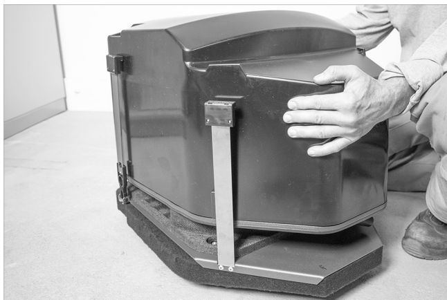
Fig. 11: Desmontar la cámara de aspiración
