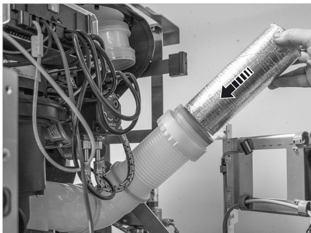
Fig. 79: Introducir el silenciador largo abajo
